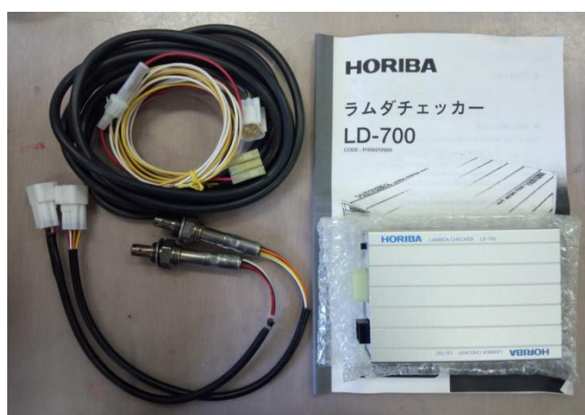
図6 株式会社堀場製作所様にご提供頂いたラムダチェッカー
