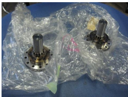
図 7 株式会社鬼頭歯車様に加工して頂いたエンジンダイナモ用の軸
