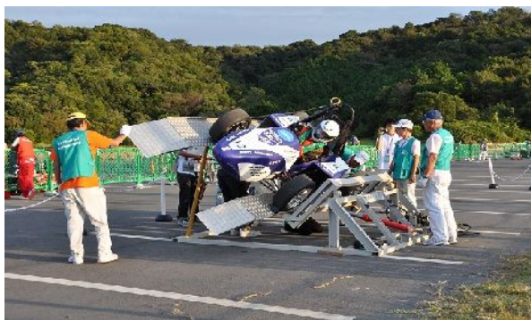
図9 チルト試験の様子
