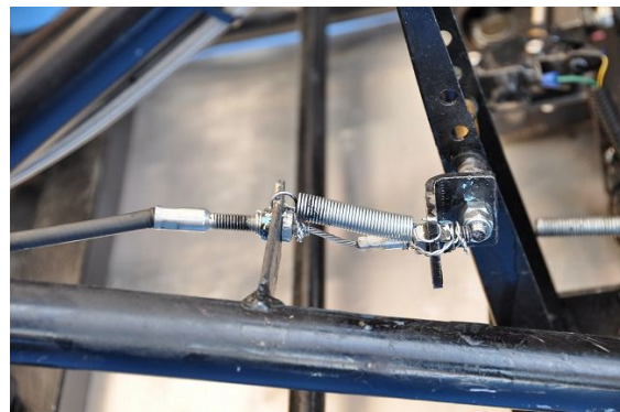
図19 故障したアクセルワイヤー
